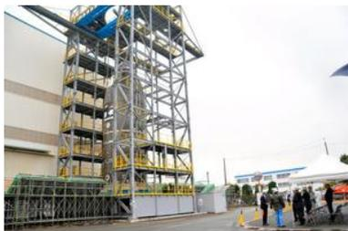
[宇宙航空研究開発機構](#)（JAXA）と[三菱重工業](#)は17日、2020年度の初打ち上げをめざす次期ロケットH3の先端カバー「フェアリング」の分離試験を行った。試験は無事終了した。
