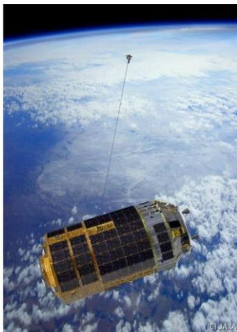
JAXAが2017年に行った、「こうのとりのり」6号機を使った「HTV搭載導電性テザー実証実験(KITE)」の想像図。不具合が発生し、完全な成功とはいかなかったものの、一部の技術要素については実証できたとし、そしてビジネスへ活かされようとしている (C) JAXA
