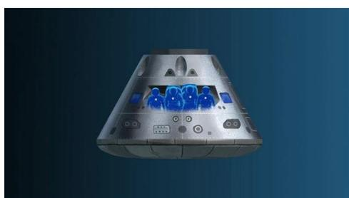
宇宙飛行士を送り込むための宇宙船にはオリオンが利用されています。オリオンは3つのモジュールで構成されており、宇宙飛行士たちが乗り込むことになるのは「クルーモジュール」で、最大4人まで収容可能。クルーモジュールの天面には別モジュールと接続するためのドッキングポート、底面には熱を遮断するためのヒートシールドが搭載されています。
