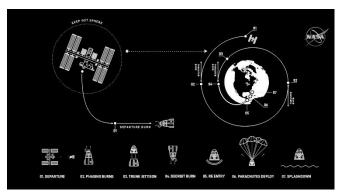
ドッキングが完了すると、Crew Dragon は与圧され、宇宙飛行士が ISS に移乗できる。 ISS では、ベンケンと ハーリーは実験やメンテナンスなどの業務を行う。その後 2 名は Crew Dragon 戻り、ドッキングを解除、貨物 コンパートメントを投棄して軌道離脱のためにロケットを作動させる。大気圏再突入後、十分に減速した段階で パラシュートを展開して大西洋に着水するという予定だ。ISS 離脱からから着水までには約 24 時間かかる。
