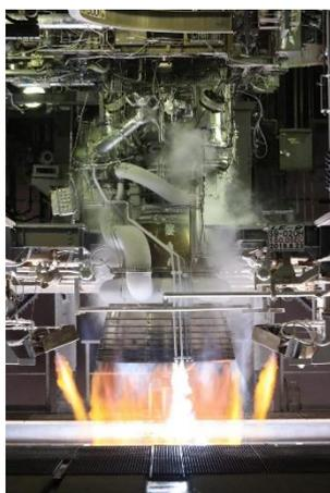
LE-9 実機型エンジン燃焼試験の様子 (Credit: JAXA)
