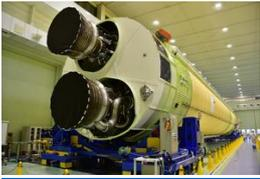
H3 ロケットの1段目。エンジンが2基取り付けられている=2021年1月23日、愛知県飛
