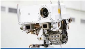
[火星探査車「パーサヴィアランス」に搭載された2台の「Mastcam-Z」（グレーのボックスに入っている）は、探査車のアンテナと一体化されている。](#)
