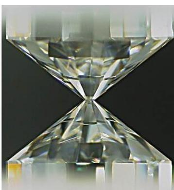
[地球の内部構造 \(東京大学提供\)](#) [高圧高温状態を発生する装置 \(左\) と内部。2つのダイヤモンドで試料を挟み込み、レーザーを照射する \(東京大学提供\)](#)
