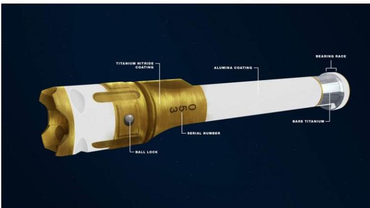
【▲ Perseverance に搭載されているサンプルチューブの外観。掘削時、サンプルは図に描かれたチューブの右端から内部に入る (Credit: NASA/JPL-Caltech)】
