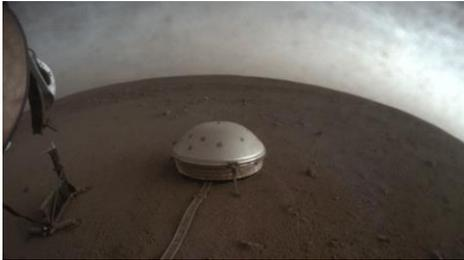
【▲ インサイトに搭載された超高感度の地震計 SEIS の画像。その上を火星の雲が吹き流れていっています。(Image Credit:NASA/JPL-Caltech)】
