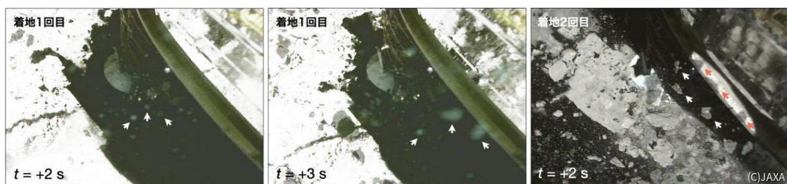
(左・中央)1 回目の着地 2 秒後、3 秒後の CAM-H 画像。サンプラーホーン下部から、矢印をつけた粒子が CAM-H に向かって飛んでくるのがわかる。(右)2 回目の着地 2 秒後の CAM-H 画像。白矢印の粒子は、ロケット結合リングに映る影から cm サイズであることが確かめられた (C)JAXA (出所:JAXA ISAS Web サイト)
