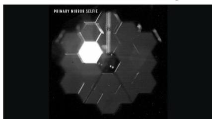
NIRCam 内の特殊な“瞳結像レンズ”を使って撮影されたウェブ宇宙望遠鏡の主鏡
