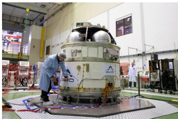
【▲ 振動試験中の上段モジュール。2018年11月撮影（Credit: ESA）】
