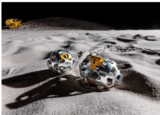
【▲ 変形型月面ロボット「SORA-Q (LEV-2)」。左は変形前、右は変形後の様子 (Credit: タカラトミー)】
