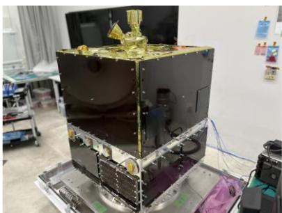
人工流れ星衛星 3 号機(ALE-3)のエンジニアリングモデル。(出所:ALE Web サイト)
