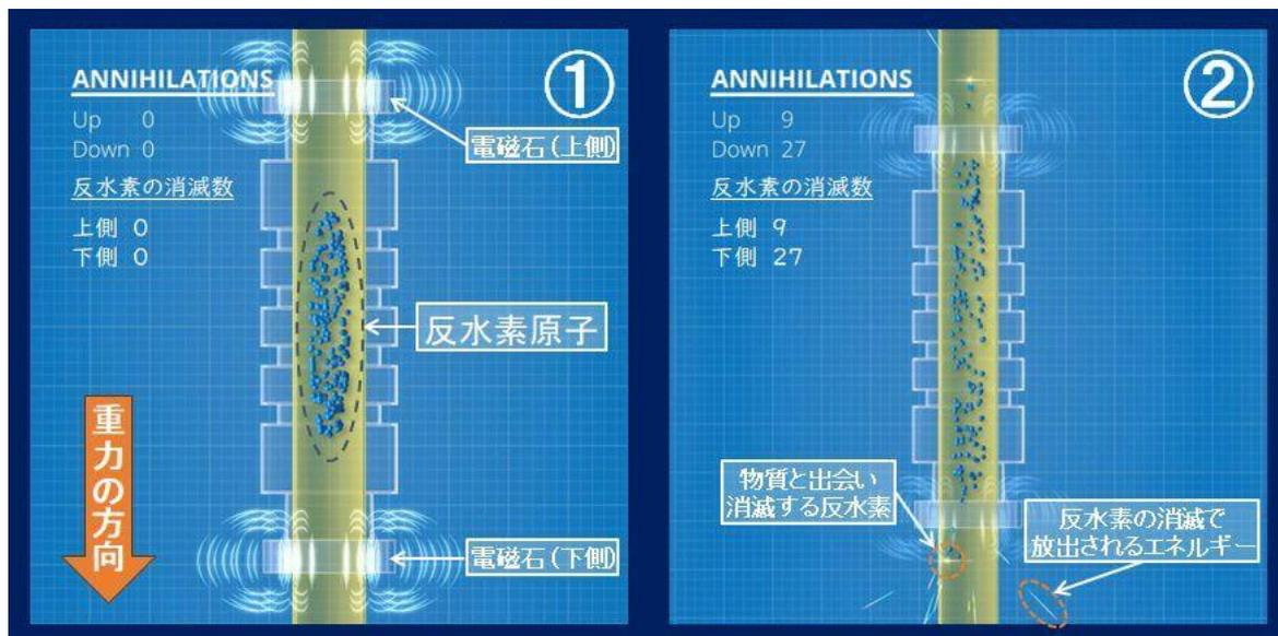
【▲図 4: 今回の実験の概略。①実験開始時には、上下を磁力で閉じ込めた真空パイプ内に反水素元素を約 100 個生成します。②上下の磁力を徐々に弱めると、反水素は落下または浮上します。出口から出た反水素は物質と出会って消滅し、エネルギーを放出するため、上下どちらに幾つの反水素が移動したのかを数えることができます (Credit: Keyi "Onyx" Li, U.S. National Science Foundation / アニメーションから引用、日本語訳および説明の加筆は筆者による)】
