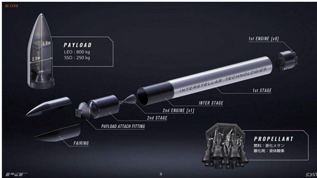
ZEROは2段式で、SSOに250kgの打ち上げ能力を持つ (C)IST
