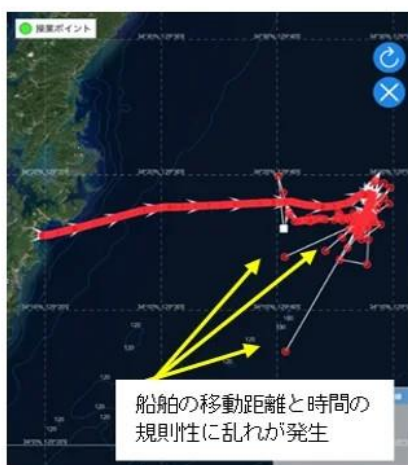
図1. GPSの精度問題が発生した航跡例
