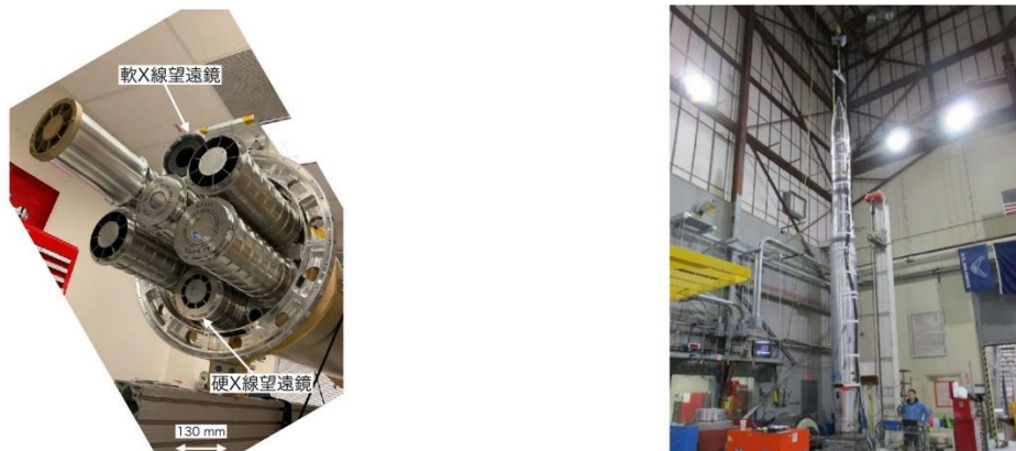
FOXSI-4 に搭載される全 7 台の軟・硬 X 線望遠鏡の外観画像。日本からは 2 台が提供された(出所:名大プレスリリース PDF)
