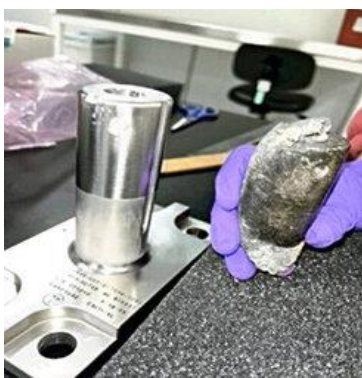
民家を直撃した金属片（右）と実際の支柱（NASAサイトから） 写真を拡大
