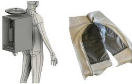
新しいバックパック型の尿ろ過装置（左）と宇宙飛行士が着用する下着（右）の側面図。(画像提供: カレン・モラレス、右画像はクレア・ウォルター提供)
