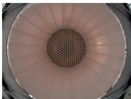
【▲ 図 1: XENONnT の内部にある検出器を撮影した写真。（Credit: XENON Collaboration）】
