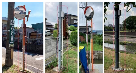
久留米市に設置している IoT 浸水深センサの一例
