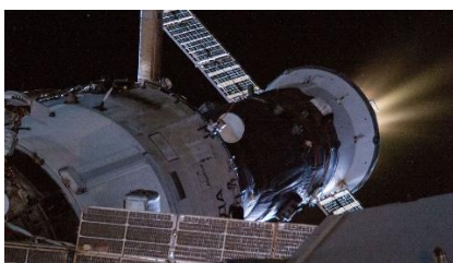
補給機プログレスのスラスタ燃焼。通常はこの推力で ISS の速度を上げ、
